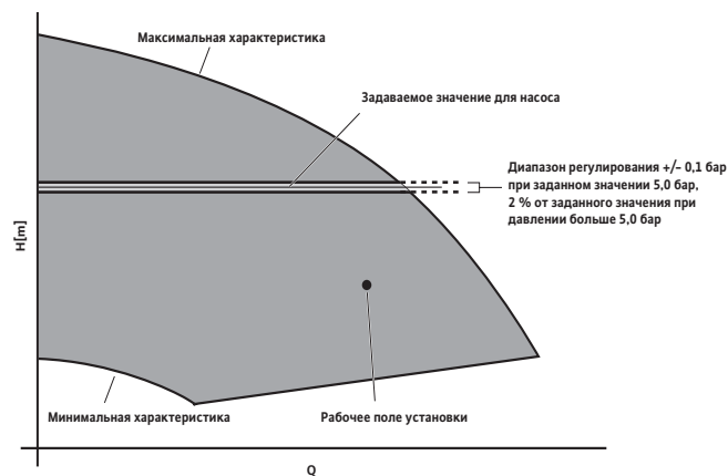
Работа регулятора Comfort-Vario VR-1
